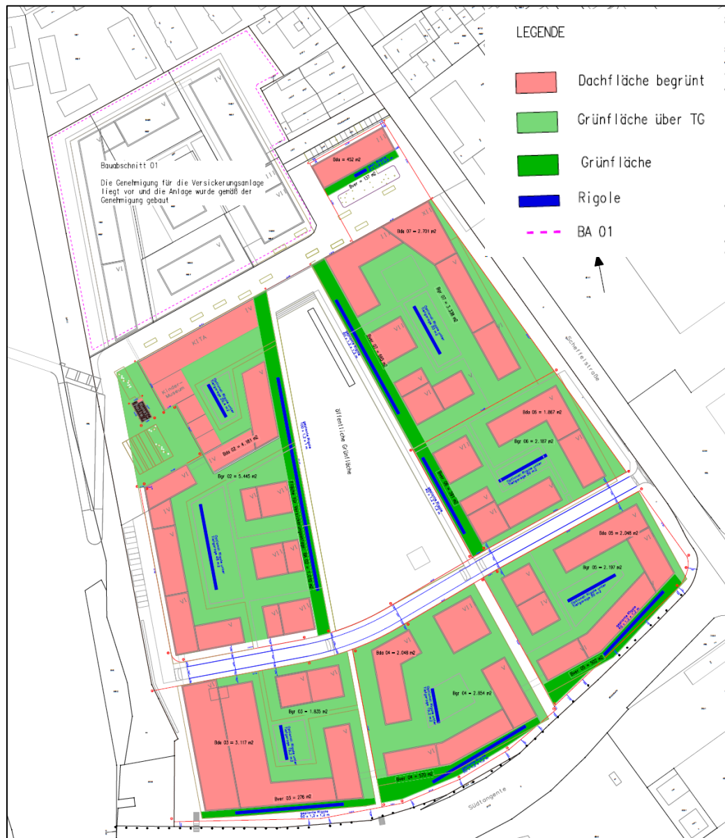
Abb.: Masterplan mit Flächeneinteilung mit Versickerung (Quelle: Manfred Dzengel, IB für Tiefbau, 2023)
