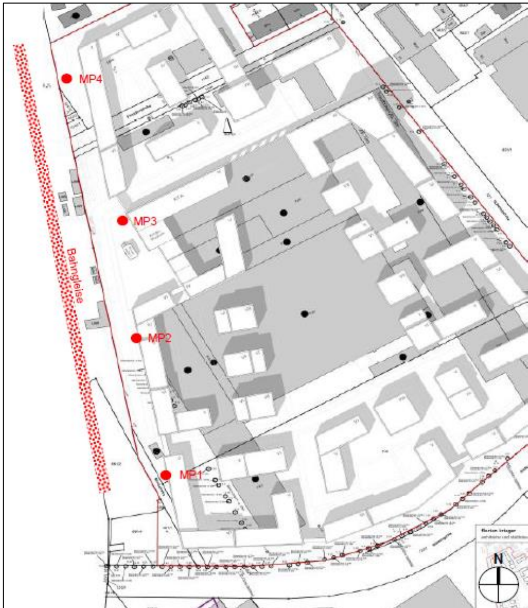
Abb.: Lageplan mit Darstellung der Messpunkte und der Bahnlinie (Quelle: IB Kurz + Fischer, Winnenden, 2019)
