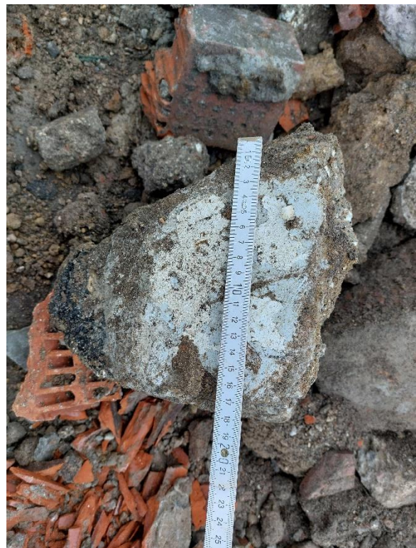
Abb. 7 Deatil: Betondecke mit Straßenaufbruch
