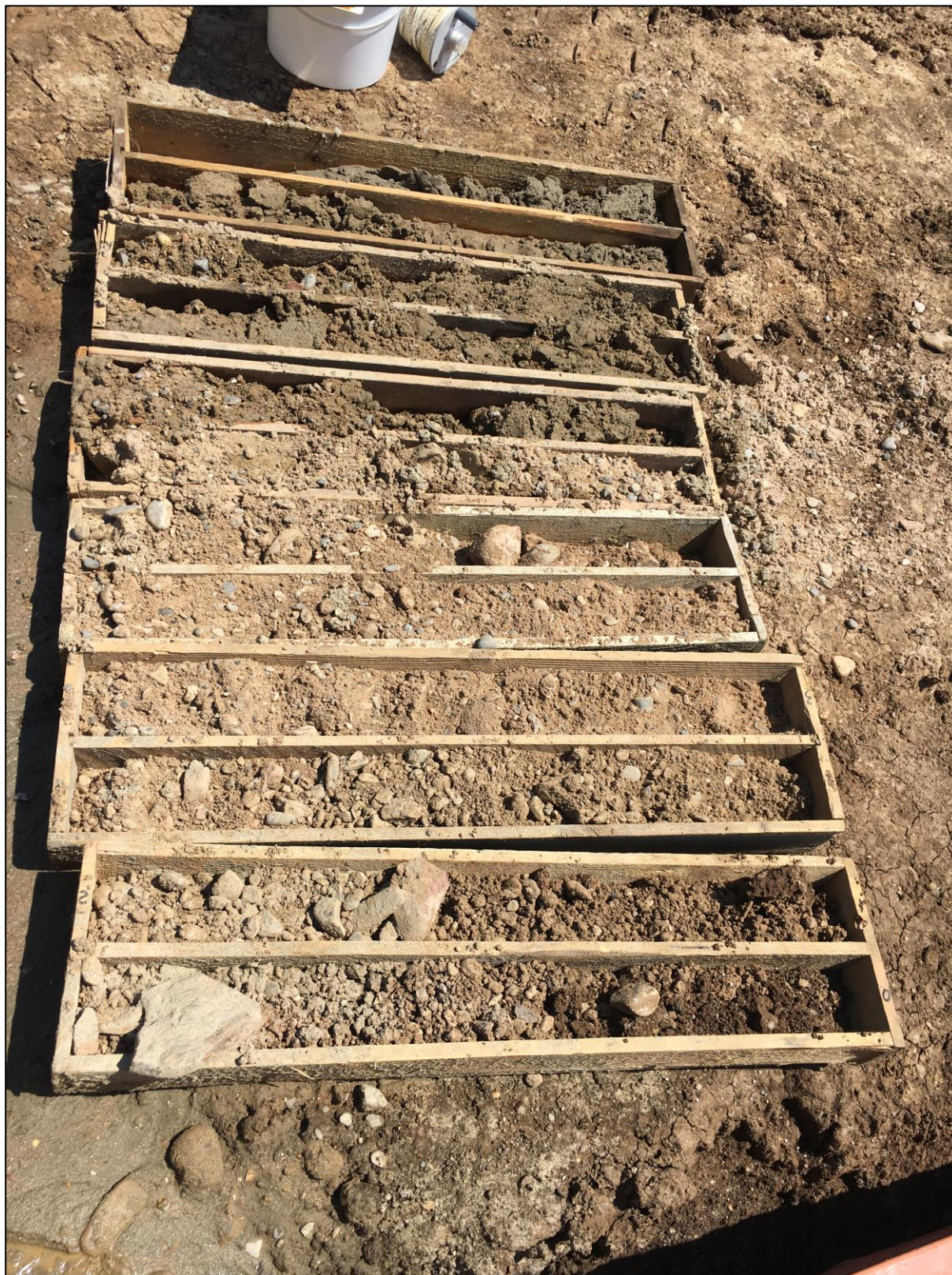
Bild 2: Bohrung GWM 1_2021, Schichtaufbau (oben Kernkiste = 1. Bohrmeter)
