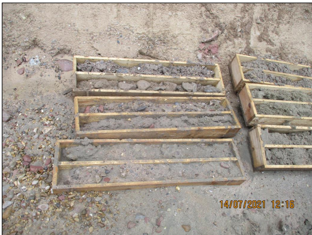
Bild 4: Bohrung GWM 2_2021, Schichtaufbau (Kernkiste obenlinks = 1. Bohrmeter)
