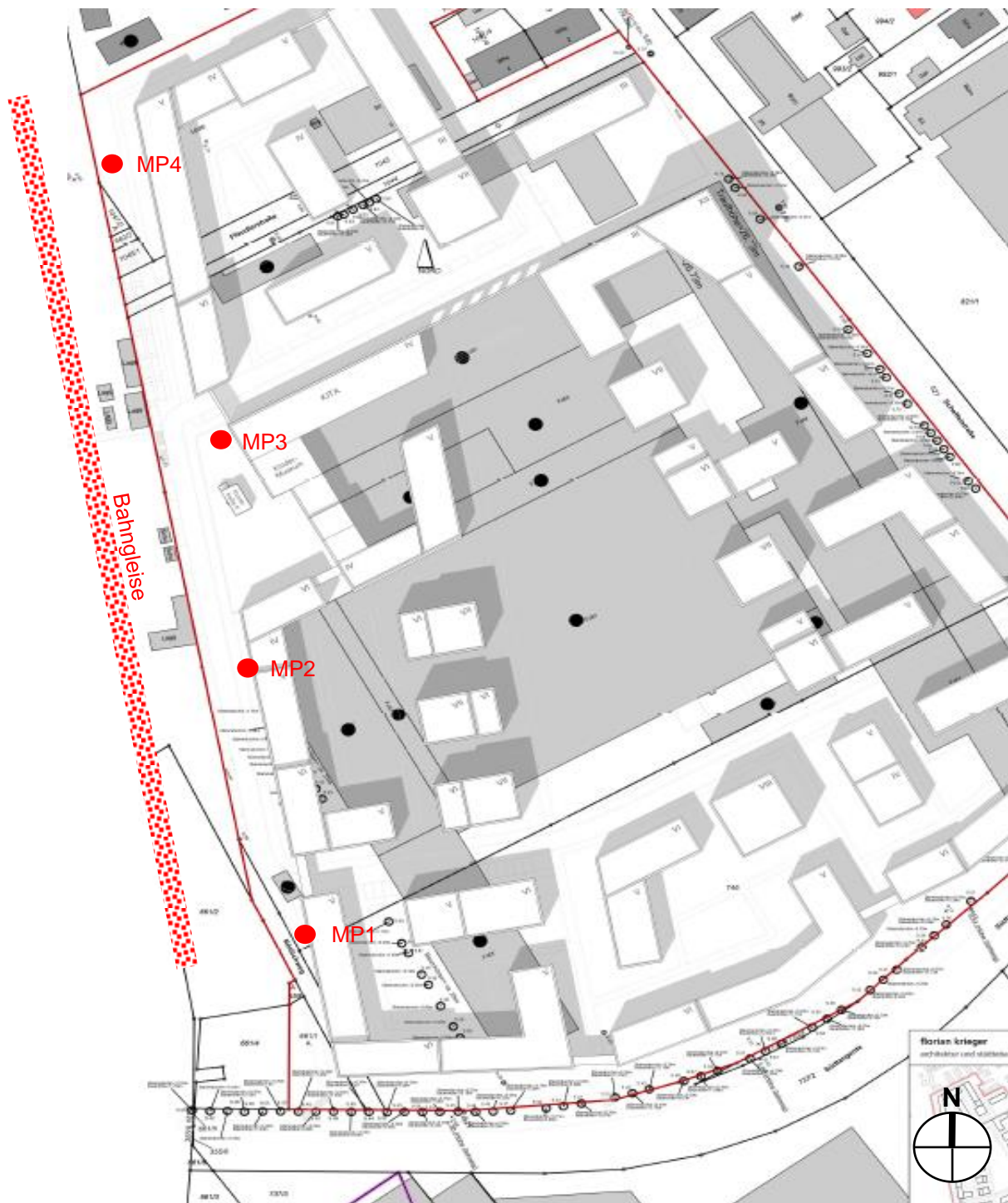
Abb. 01: Lageplan (Überlagerung Bestand und Planung) mit Darstellung der Messpunkte und der Bahnlinie
