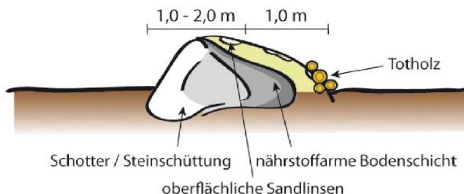
**Abbildung 8:** Schema zur Anlage von Stein-Totholz-Riegeln
