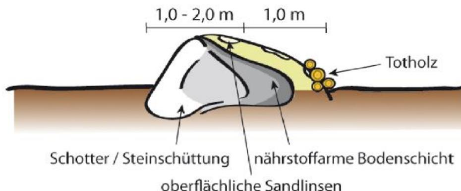
**Abbildung 6:** Schema zur Anlage von Stein-Totholz-Riegeln
