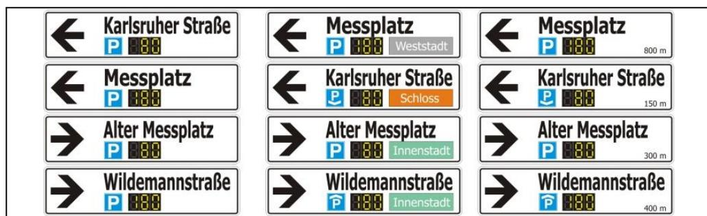
Abbildung 1: Wegweisung Parkleitsystem im Bestand, mit Kennzeichnung von Bereichen durch zusätzliche Farbbalken und mit Nennung der Entfernung (v.l.n.r.)<sup>7</sup>
