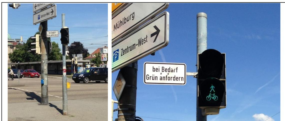
Abbildung 3: Beispiel einer DUNKEL-DUNKEL-Anlage in Karlsruhe (links: Ruhezustand: die Vorrangregelung gilt; rechts: nach GRÜN-Anforderung durch Fußgänger wird die Furt signaltechnisch gesichert).
